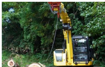
伐採した木を道なき山から降ろすには ウインチを使って運搬します
