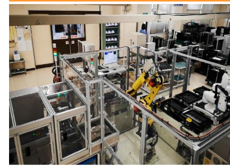
基板分割と検査の自動化ライン
