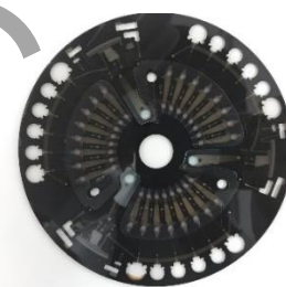
検査用カートリッジ φ120mm t1.2mm
