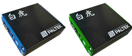
車両運動/EVプラントモデル内蔵 リアルタイムシミュレータ 「白虎」
