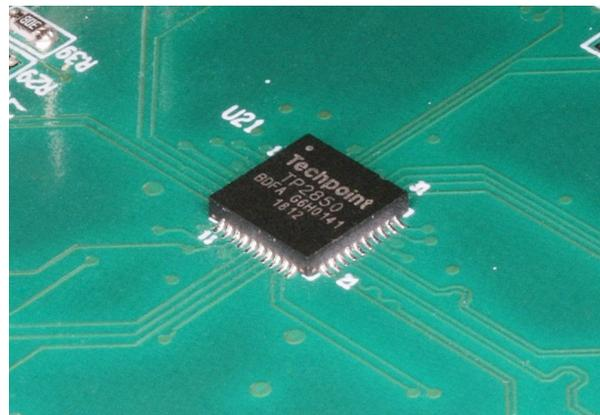
⇒DDPAI社が展開する2カメラタイプおよび電子ミラー一体型タイプの4シリーズ（「Q2、Q3、E3、E5」）のドライブレコーダーに、当社製映像受信用半導体「TP2850」および映像伝送方式として当社独自規格「HD-TVI」が採用
