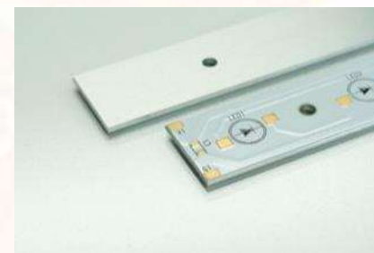
金属板がベースの放熱性に 優れるメタル基板は、 熱を持ちやすい製品に多用
