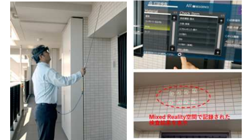
HoloLens 2を付けた 打診検査の様子
