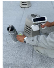
試験ボール投入の様子
