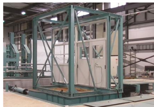
耐震試験装置を活用して地震動対策化を図った「学校用間仕切」
