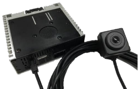
新開発した車載用FIRカメラ
