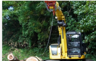
伐採した木を道なき山から降ろすには ウインチを使って運搬します
