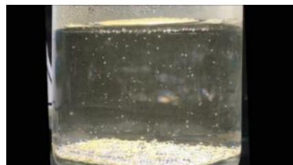
光触媒シート(3 cm×3 cm)による水分解
