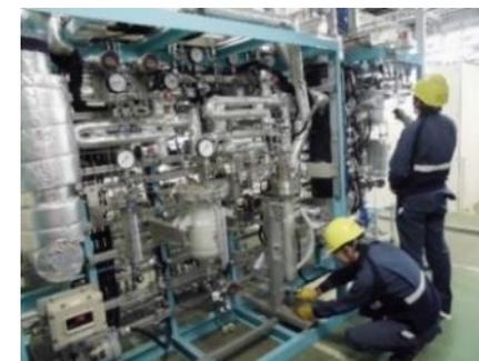
反応分離型メタノール合成パイロット設備
