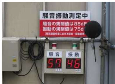
作業所の騒音・振動の管理
