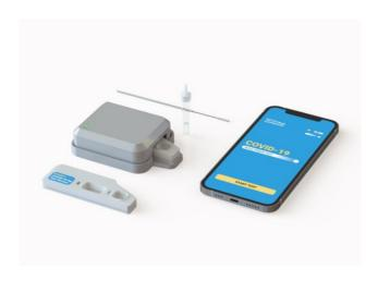
Xtrava Health 社が開発したリーダーと LED 光源を用いて、リーダーに挿入した抗原迅速診断キットの判定ラインを目視よりも正確かつ高感度で陽性または陰性を判定できる。スマートフォンを通じて診断結果をクラウドや電子カルテへ送信・蓄積できる他、位置情報と連動させて各地域の感染状況を把握することもできる。
