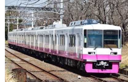
新型VVVFインバータ装置により 現行の8800形と比較し使用電力量削減
