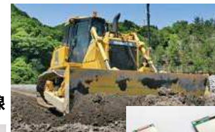
GNSSシステムブルドーザ
