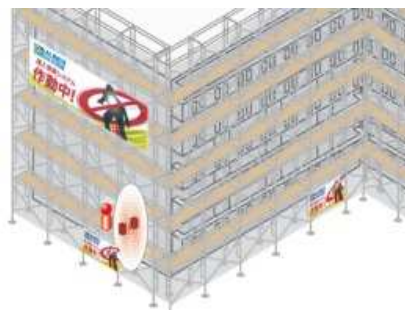
仮設足場侵入警報システム
