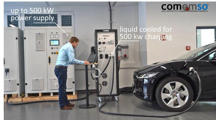
次世代/超急速充電対応・EV充電シミュレータ
