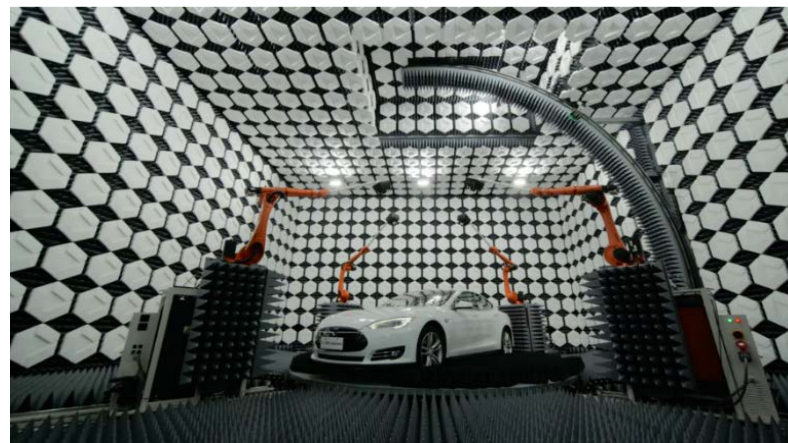
コネクティッドカー向け無線通信性能計測システム
