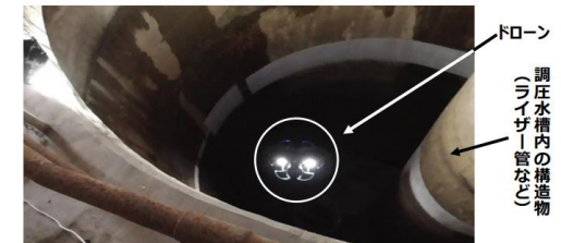
▲調圧水槽内を降下しながら壁面を撮影するドローン
