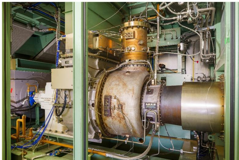
＜液体アンモニアと天然ガスを混焼した2,000kW級ガスタービン(IHI 横浜事業所内)＞
