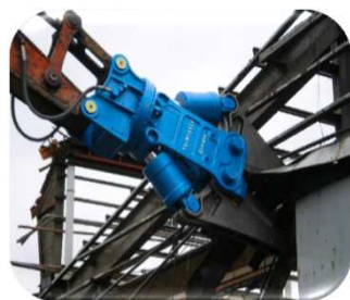
ビル解体用 圧碎機（鉄骨カッター）
