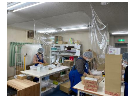
作業現場における飛沫防止シートの設置
