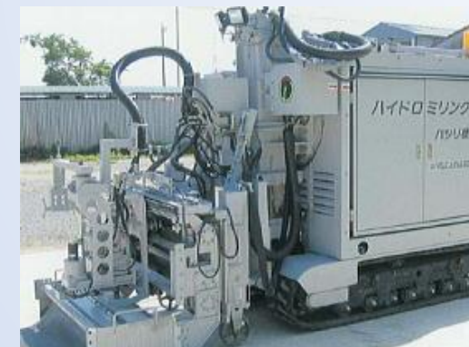
コンクリート除去作業装置
