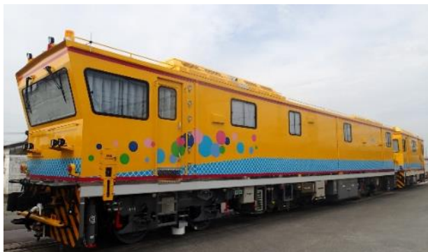
レール内部の傷に対し、 超音波探傷による非破壊検査を行う レール探傷車
