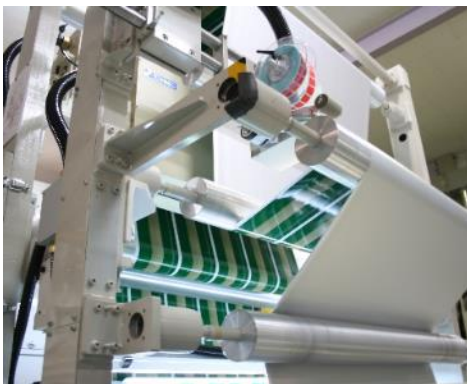
印刷の不良率の削減と印刷品質の確保を実現する 印刷品質検査装置
