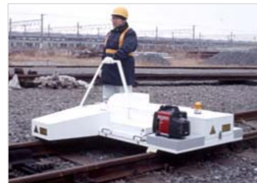
分岐器内のレールやクロッシングの摩耗量、 軌道変位等を同時に測定できる 分岐器検査装置
