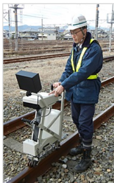
レール探傷車より小回りが利き、 ピンポイントで探傷箇所を特定できる レール探傷器
