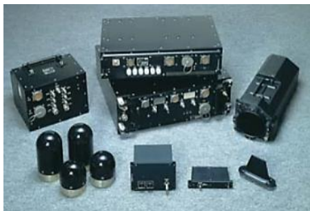
航空機を取り巻く電波を瞬時に分析し、パイロットに危険なレーダー照射などの警報を発するレーダー警戒装置
