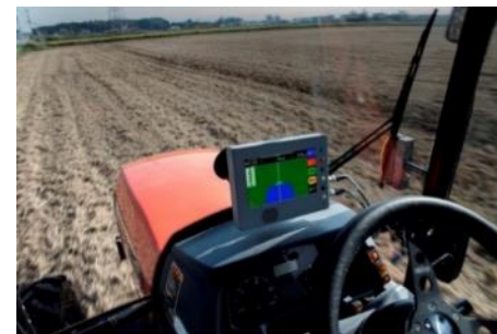
農作業の負担軽減のためのトラクタ直進自動操舵補助装置
