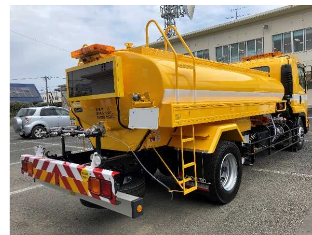
散水車 (給水機能付)
