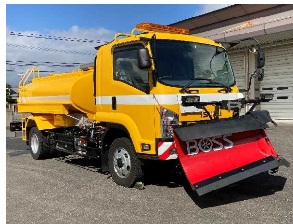
散水車 (除雪機能付)
