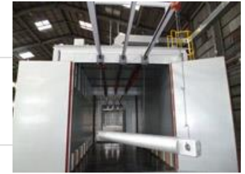
大型塗装設備
