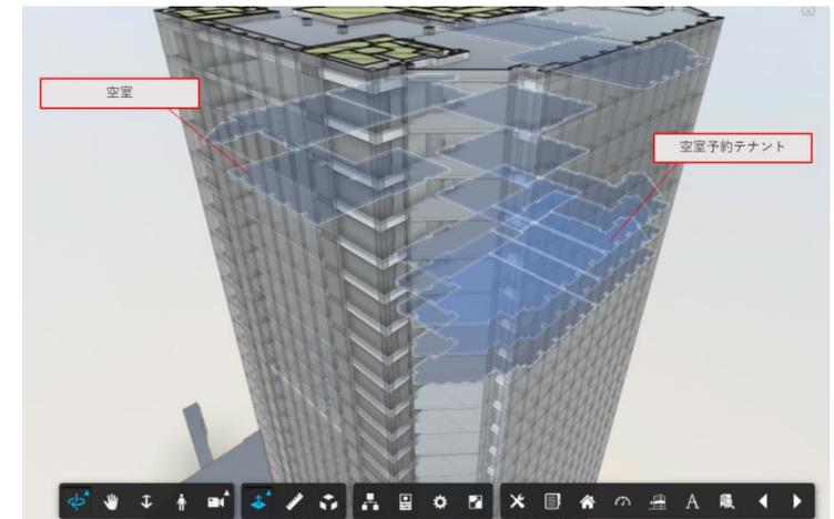
※ BIM とは、Building Information Modeling (ビルディング インフォメーション モデリング) の略称で、コンピュータ上に作成した3次元の建物のデジタルモデルに、コストや仕上げ、管理情報などの属性データを追加した建築物のデータベースを、建物の設計、施工から維持管理までのあらゆる工程で情報活用を行うためのソリューションであり、また、それにより変化する建築の新しいワークフロー
