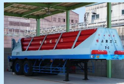
水素ガスカードル
