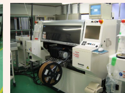
多機能タイプマウンター (BGA・CSP・大型コネクタ対応可)
