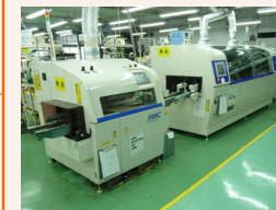
(左) スプレフラクサー装置 (右) 自動はんだ付装置 (N2対応)
