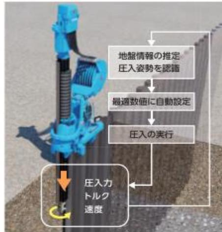
自動運転モードで地盤情報を推定し、圧入力、圧入スピードを最適化
