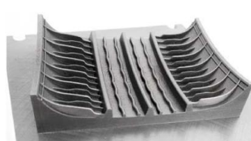
金属粉末による3D造形例 (タイヤ金型) 従来の技術では製造困難な 複雑形状を一体成形
