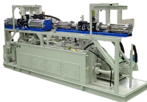
水素ステーション設置型の 高圧型水素圧縮装置
