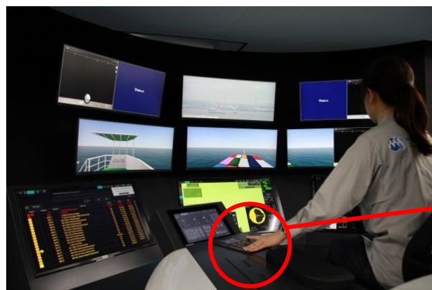
フリートオペレーションセンターの非常対応ブロック (遠隔操船機能) (ジョイスティックコントローラは操作者左手部分)
