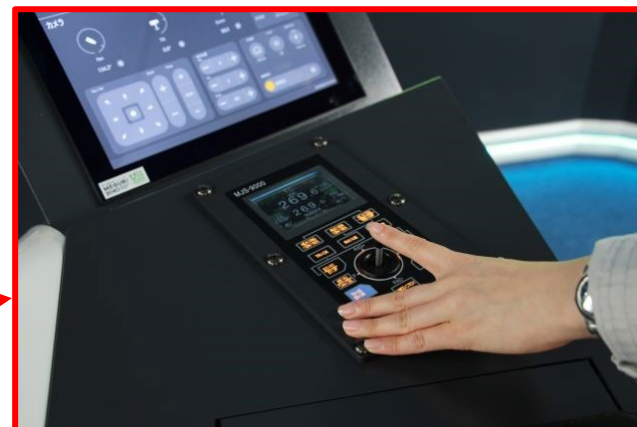
非常対応ブロックに搭載された 東京計器のジョイスティックコントローラ
