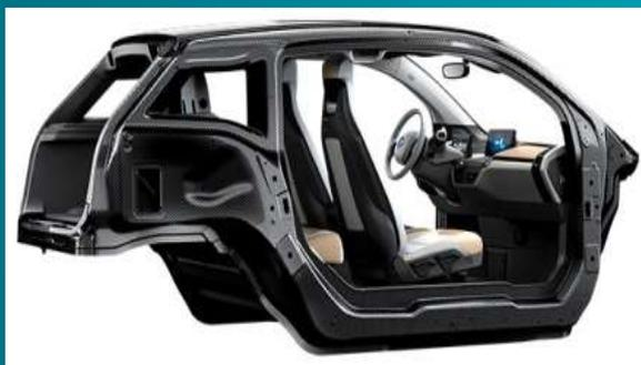
◀ CFRP製の自動車部材
