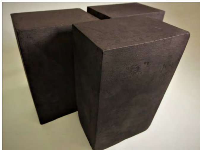
廃棄黒鉛材を原料に用いた リサイクル黒鉛材の試作品
