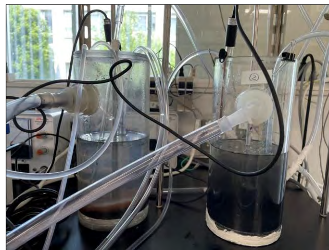
リサイクル黒鉛粉に担持したアナモックス細菌 を利用した汚水処理実験
