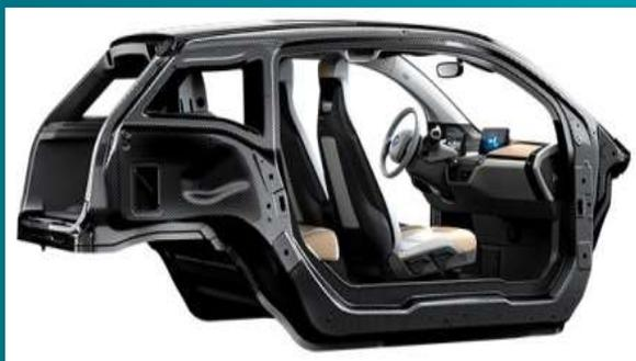
◀ CFRP製の自動車部材
