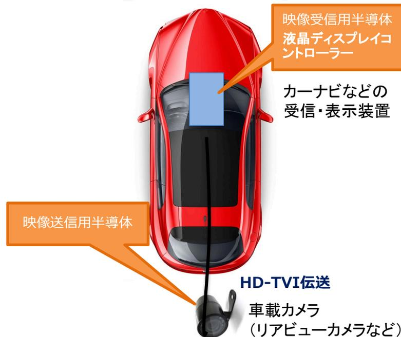
映像の送受信にはアナログ方式とIP (デジタル) 方式に大別されますが、当社は普及済みのアナログ用配線を用いることで安価ながらも高画質映像 (HDから4K画質まで) の送受信を可能にする技術を有し、それを用いた当社半導体製品は監視カメラ・DVRメーカーおよび車載のドライブレコーダー・車載カメラ・カーナビメーカー等に採用いただいています。
