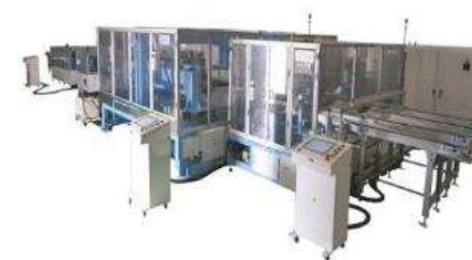
■ パネル解体装置
