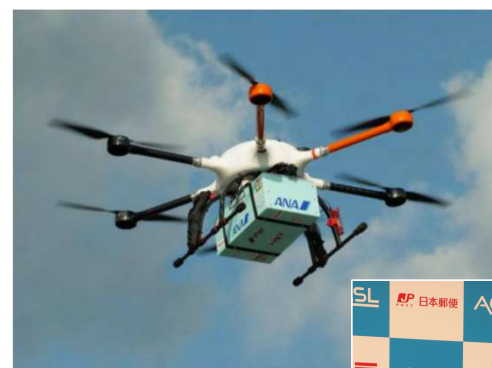
5kgペイロードの中型物流ドローン実証において実際に荷物を運ぶ様子
