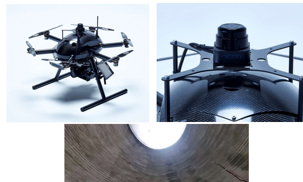
左上: 煙突点検用ドローン（ACSL-PF2）
