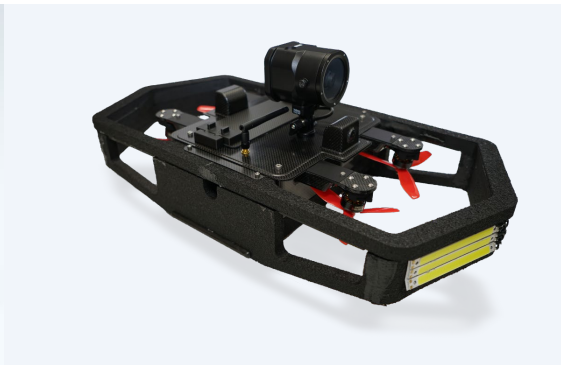
閉鎖環境点検 (Fi4)
