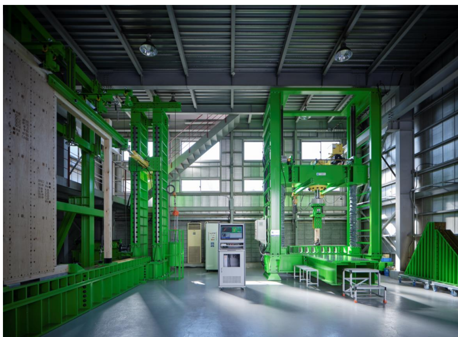
<1000 kN (100 トン) 万能試験機 (右)、200 kN (20 トン) 面内せん断試験機 (左) >
