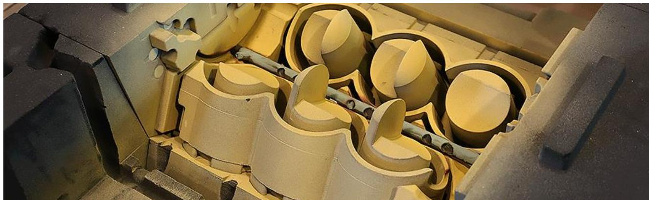
砂型鑄造で使われる木型を介さず、3Dプリンターでの鑄型を作成する砂型鑄造法の推進
