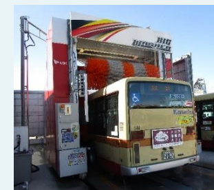
茅ヶ崎営業所で稼働している超節水型バス洗車機
