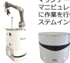
マップデータを元に走行を行い、マニピュレーターが人の代わりに作業を行います。ロボットシステムインテグレーターだけでなく、自社オリジナル搬送ロボットも開発中。
