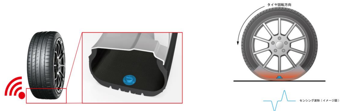
タイヤ内面貼り付け型センサーのイメージ
