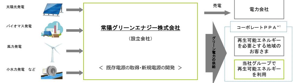
\*1 自社敷地・屋根(オンサイト)や自社隣接地等(オフサイト)に太陽光パネルを設置し、 小売電気事業者を通じて再生可能エネルギーを供給する仕組み。
