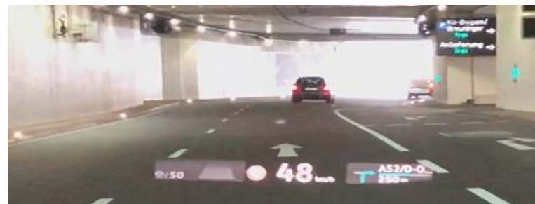
「ID.4」のヘッドアップディスプレイ（欧州仕様車）。フロントガラスに走行情報が浮かび上がる
