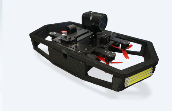
閉鎖環境点検 (Fi4)
