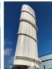
硬翼帆。風向きや風速に従って自動的に伸縮・方向変換が可能
