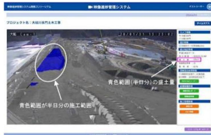
盛土の施工範囲とその施工量確認イメージ
