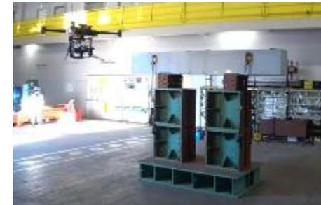
ドローンによるRC試験体の計測状況
