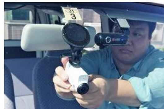
フロントガラスに取り付けたGPS搭載カメラで路面を撮影し、ひび割れやわだち掘れを検知する
