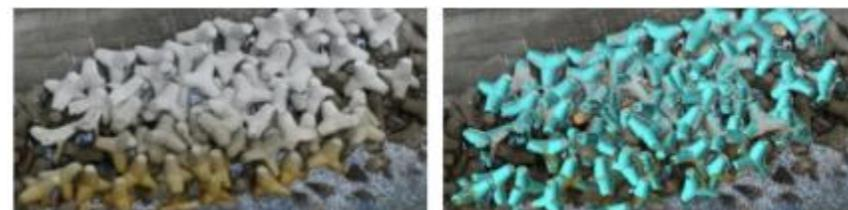
消波工の出来形再現 (施工情報の3D化)
