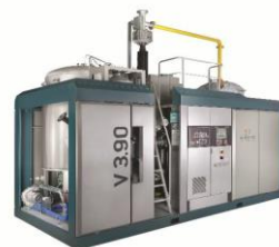
ガス化ユニット
