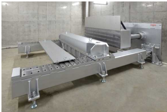
圧壊試験機(第1安全試験室)
