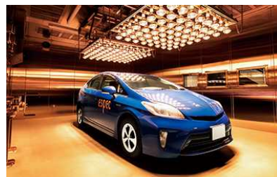
自動車一台入る 実車試験装置
