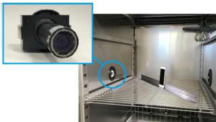
槽内監視カメライメージ
