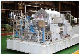
アンモニアプラント用圧縮機
