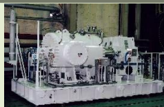
パイプライン用圧縮機
